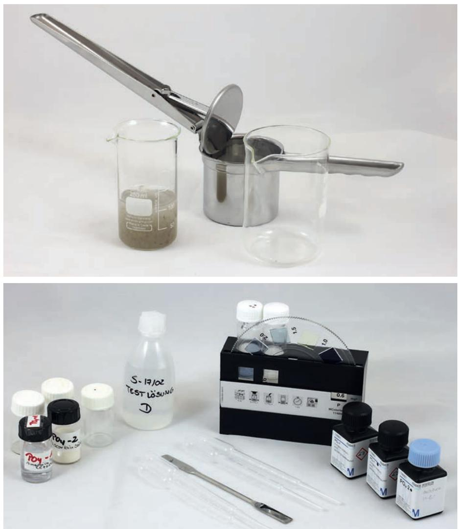
Abb. 1. Impressionen der Experimente (links: Reinigung des „Modell“-Klärschlamms; rechts: Semiquantitative Bestimmung der Phosphatkonzentration mittels MColorTest™ der Firma Merck) Quelle: Christian Zowada
