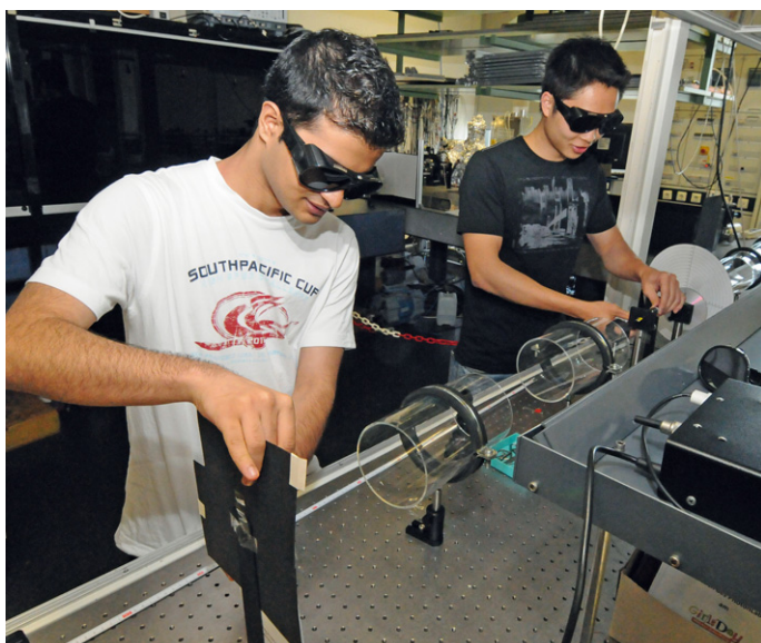
Messung der eigenen Haardicke mit einem Laser
